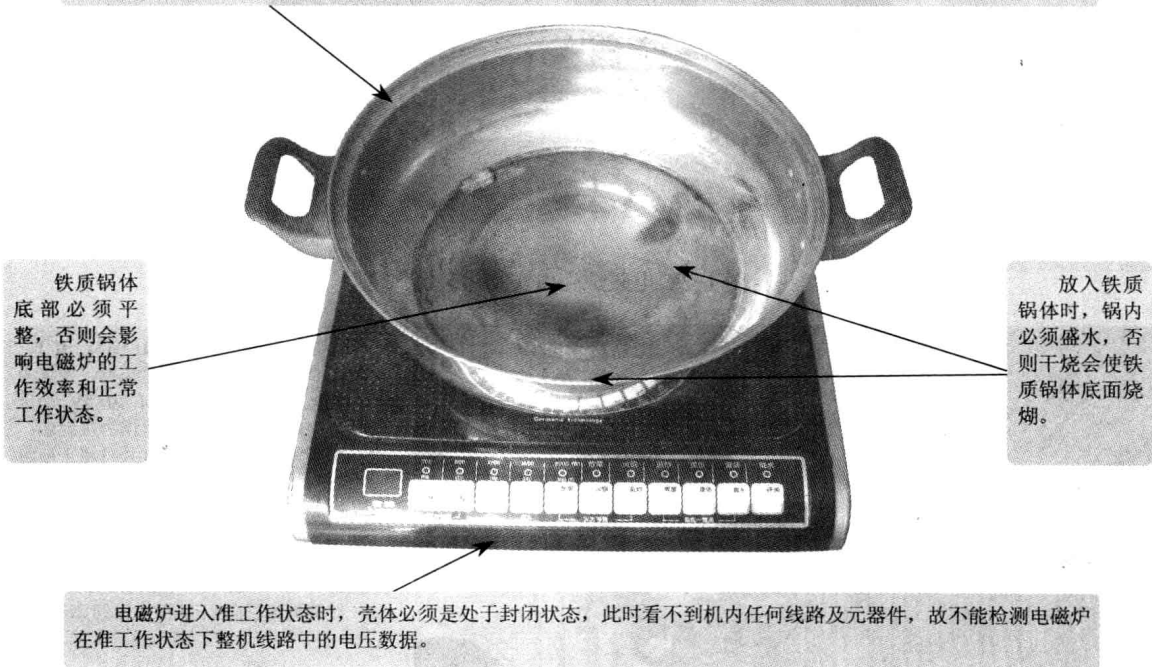
图 1-1 电磁炉正常工作状态实物图
