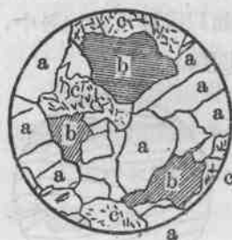
圖 8 花崗岩薄片在顯微鏡下窺見的情形。
