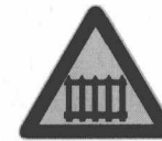
(33) 有人看守 铁路道口
