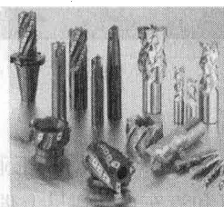
图 1-7 铣刀（合金工具钢）
