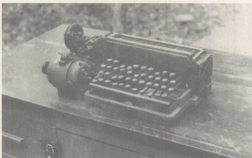
40年代使用的电报主要设备——键盘凿孔机
