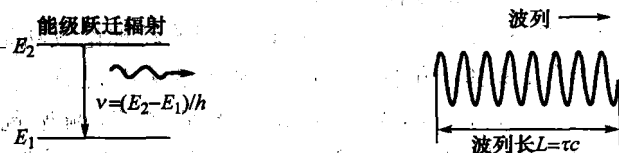
图 1-4 普通光源的发光机理
