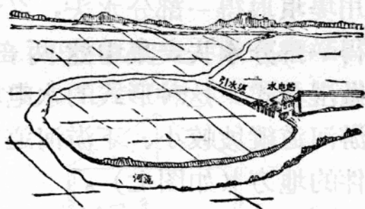
图五 利用河灣造成水头的水电站
