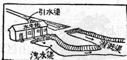
图四 灌溉渠上的渠道式水电站
