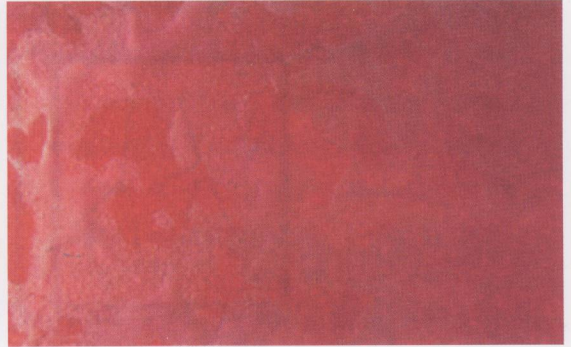
图 4-55 金属闪光层与透明层之间的起泡、剥离、开裂
