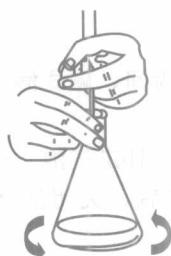
图 2-5 酸式滴定管锥形瓶滴定操作
