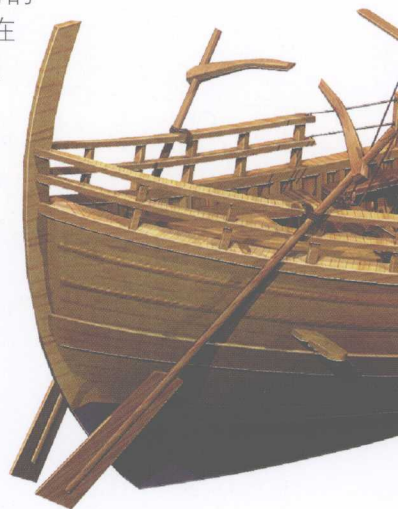
一艘公元前2400年的希腊运输船复原图。该船长30米，由四支桨驱动。远航时悬挂方形茅草帆。如果一切正常，它可以在八天内从雅典的比雷埃夫斯开到尼罗河口。
