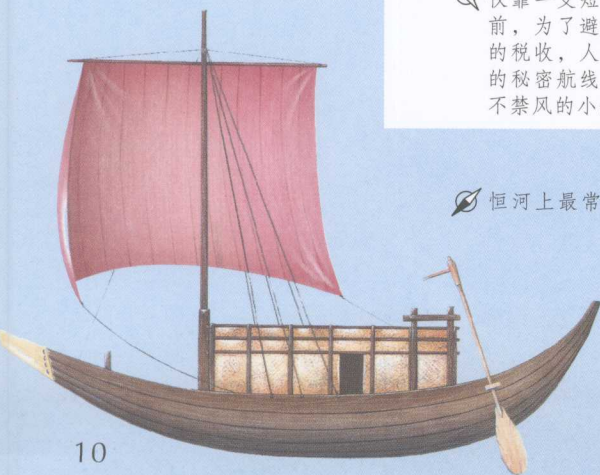
公元前2800年的克里特船复原图。船舱凿在橡木中，侧舷扎在平坦的底座上。
