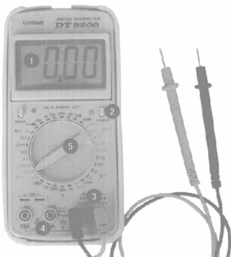
图 2-1 DT9205 3\frac{1}{2} 位数字万用表面板结构图
