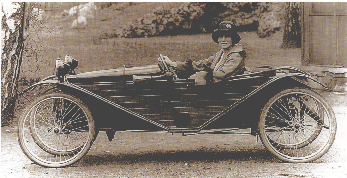
这辆斯拉拜-拜林格-双座车装配了DKW单缸二冲程发动机，汽缸容积170毫升，功率为2.5马力。
