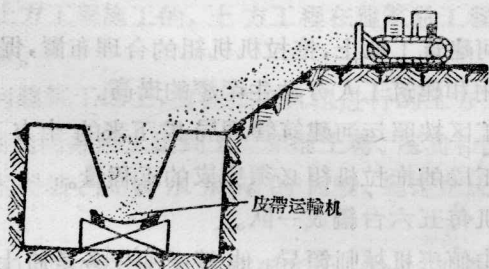
圖1 推土机向皮帶运输机坑道添撒攪合料的工作图
