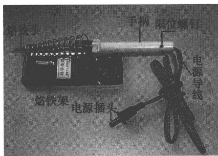
图1-3 内热式电烙铁外形结构示意图
