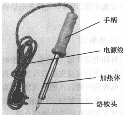
图1-4 外热式电烙铁外形结构示意图
