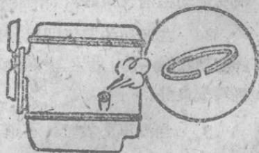
4. 如果在散热器的水里发现气泡，就表示气缸盖衬垫漏气。
