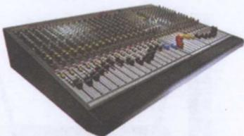
号，然后按照使用者的要求分配到不同的输出通道（通道的英文Channal简称ch），再把节目信号交给下级设备处理的设备，是前置放大器的一种。一般有多个信号输入通道和多个信号输出通道，功能模块上具有信号放大、均衡补偿、信号混合、信号分配、信号指示这几大块，电路结构上是一种矩阵（matrix）结构。
