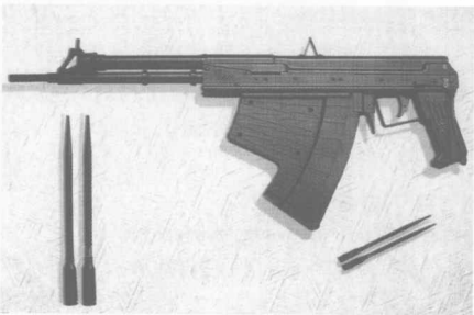
苏联5.6毫米APS型水下自动步枪及箭形弹
