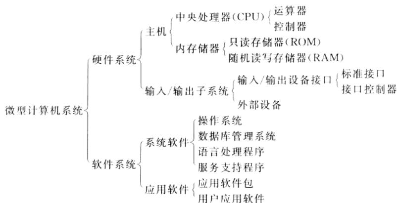
图 1.1 计算机硬件系统的组成
