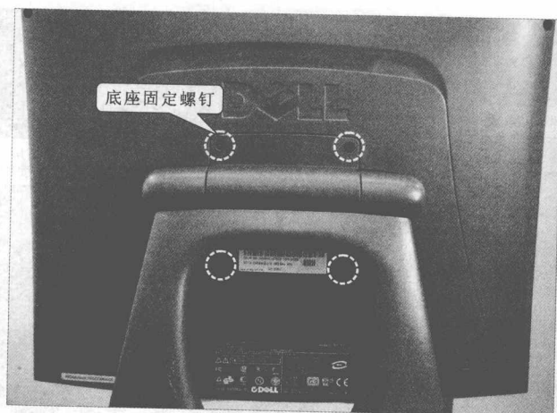
图 1-9 Dell—1702FP 液晶显示器底座的固定方式
