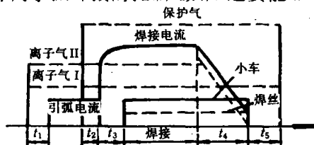
图 1-1 焊接程序控制循环图
