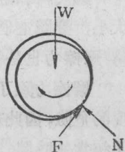
圖3 軸和軸承的間隙。
