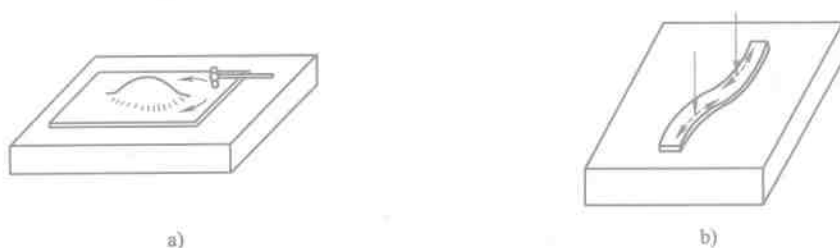
图 1—10 锤展伸长法矫正 a) 薄板凸变形的矫正 b) 窄板弯曲变形的矫正
