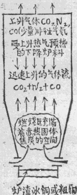
圖五 还原熔煉时 爐的断面
