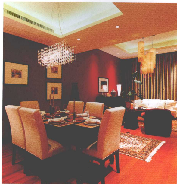
吊顶的高度变化将客厅与餐厅作了自然分割。内嵌式的灯型提升了会客区的净空高度，体现了联结又独立的良好空间层次。
