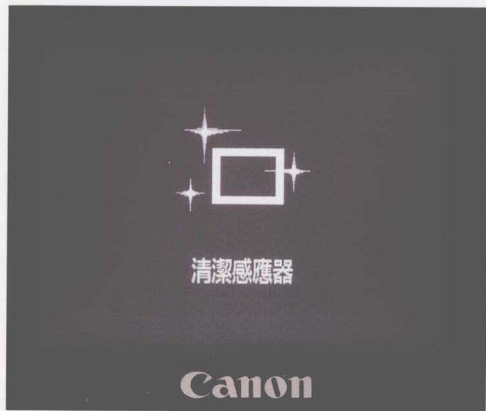
▲当相机替CMOS除尘时，会显示这个除尘图案。
