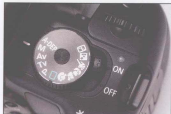
▲由于没有了以往黑白LCD，所以机顶新增电源指示灯，以让用户知道相机状态。
