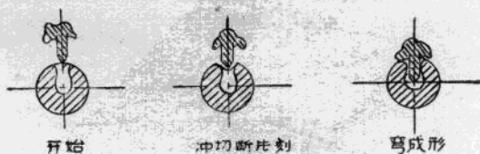
图3. 图一冲模冲切断过程原理简图
