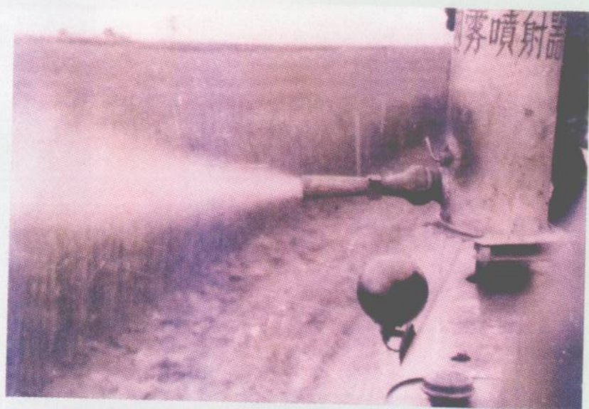
图22 安装在拖拉机上的硫磺油雾发生器
