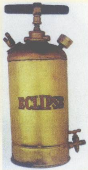
图10 两种最古老的手动喷雾器械（左图：俾斯麦公司1889年生产的上压背负式喷雾器；右图：卜内门公司1917年生产的压缩喷雾器）
