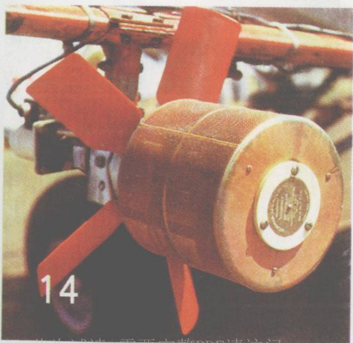
图37 安装在飞机上的 AU-3000型转笼 式超低容量雾 化器
