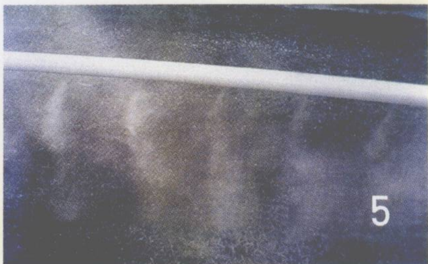
图12 与背负喷雾机配套使用的撒粒管（管的下方有许多小孔，微粒剂由小孔撒出）
