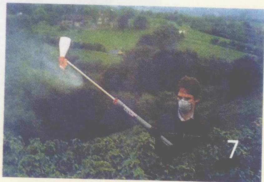
图 18 手持超低容量喷雾机的工作状态(图示飘移喷洒法,药雾向左侧随风飘移)
