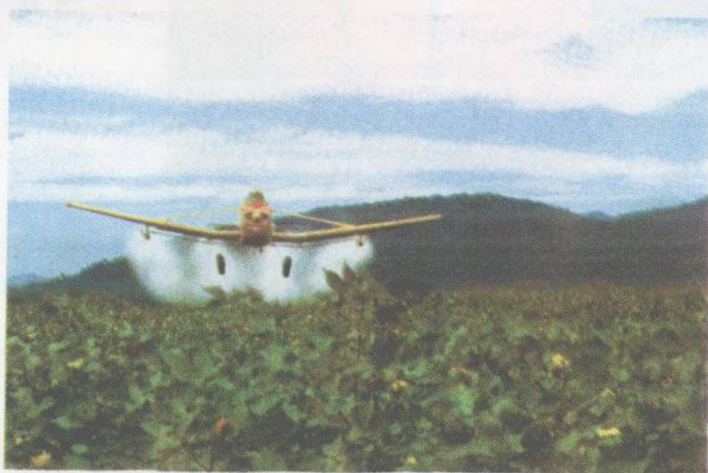
图36 超低容量 喷雾法 (喷洒杀 虫剂, 5升/公顷)
