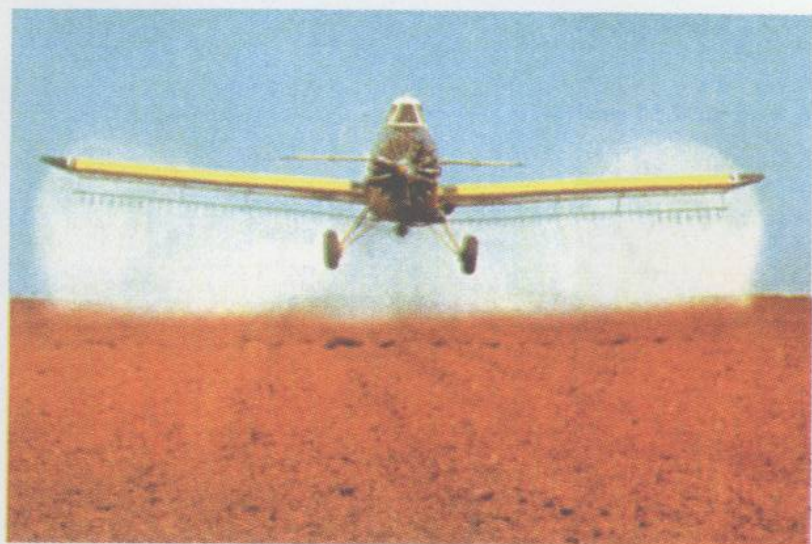
图35 常规喷雾法 (低容量喷洒 除草剂, 20~50 升/公顷)
