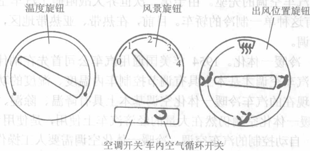
图 1.7 全自动空调操作面板
