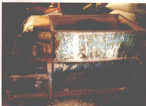
图9 料槽式拌料机
