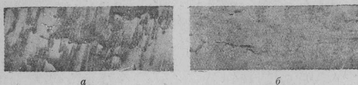
图 1-8 在一般条件(a)和振动条件下結晶时合金鋼鑄錠中心处晶間裂縫及其分布特征
