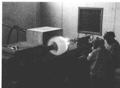
图4 球体的中频感应加热和镍基合金的热喷涂
