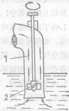
图1—6 轴流泵工作原理示意图
