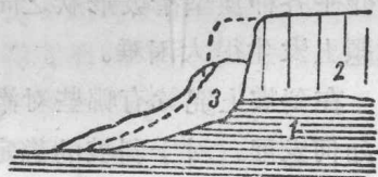
圖2r 塑性形成的亂向滑坍： 1. 粘土；2. 砂質粘土；3. 滑坍体
