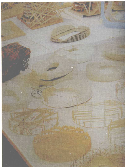
图 1-13 鸟巢概念设计结构与体块模型
