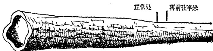
图1 根部空筒腐朽
