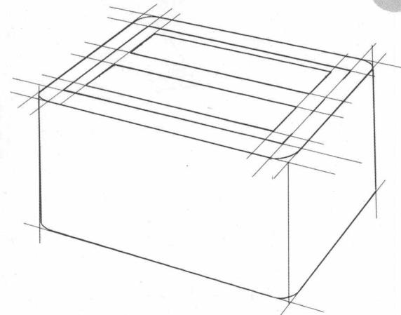
**1** 先画出烤面包机的透视线，进而绘制出一个长方体。在绘制好的长方体上面画出烤面包机的凹槽来。
