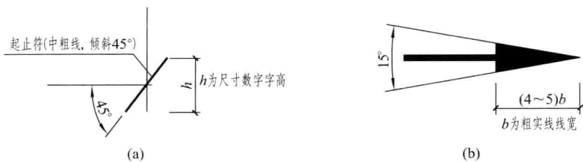
图 1-13 尺寸起止符号的画法
