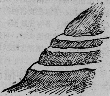
图4. 带状整地示意图
