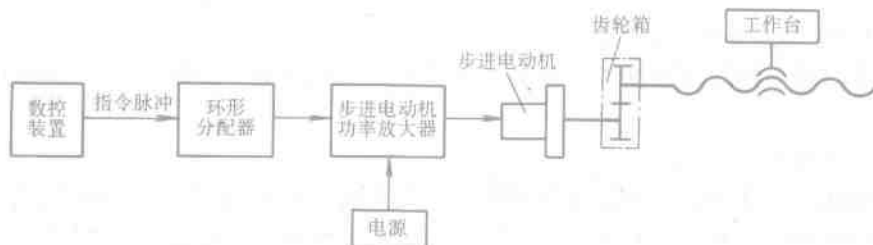
图 1—4 步进电动机开环进给伺服系统原理图
