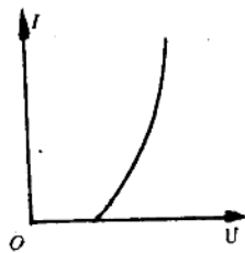
图 1-6 晶体二极管的正向伏安特性
