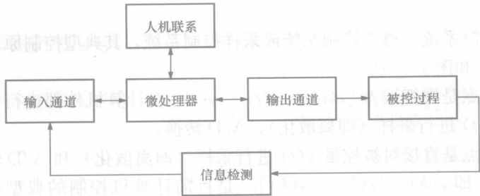
图 1-4 计算机控制系统的框图组成
