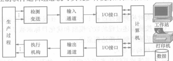
图 1-6 直接数字控制系统
