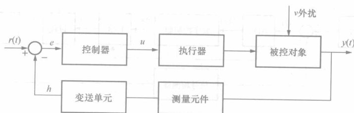
图 1-1 计算机控制系统基本结构
