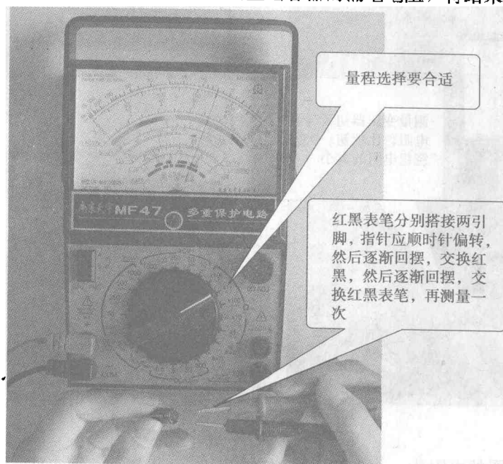
图 1-4 电容器的测试
