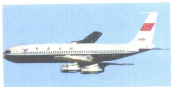
图片报道：波音707型飞机系美国波音公司制造的涡轮风扇喷气客机，安装涡轮风扇发动机4台，机身全长46.61米，翼展
