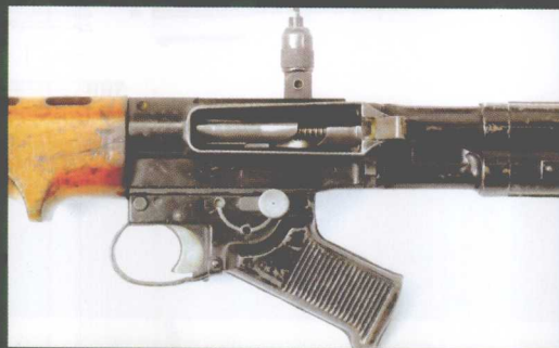
FG42伞兵步枪初期型左侧弹匣接口特写，取下弹匣后可以看到枪机上解除闭锁的沟槽
