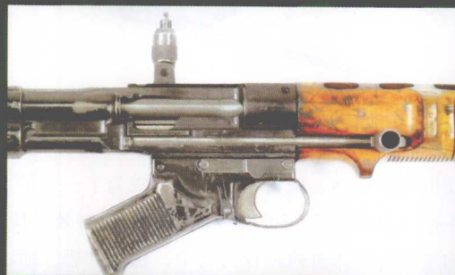
机匣右侧面特写，FG42枪机闭锁在枪管后面延长部的方式，使得减轻机匣重量成为可能
