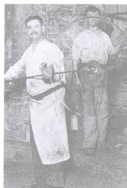
图0-7 通过旋转开敞的玻璃泡，一个平坦的玻璃圆盘被制作出来
