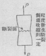
鑄鐵等不易延伸的脆性材料，其拉伸試驗圖如下圖所示。
