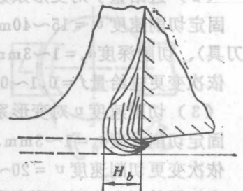
图2-3 积屑瘤高度测量简图
