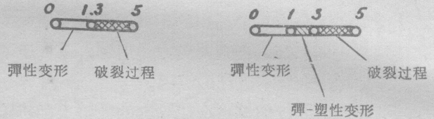
图1-16 脆性材料的变形、破裂示意图 (图注见图 1-6 中的)。
