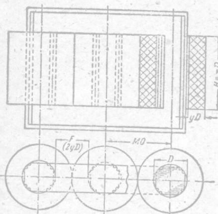
$\sigma_m$ 。鐵心截面的空間係數  $\sigma_{cm}$  表示鐵心有效截面和鐵心圓周所包围面積之比。鐵窗的空間係數  $\sigma_m$  表示鐵窗中所有導線的截面和鐵窗總面積之比。
