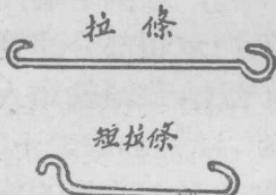
拉條共有兩根，一根較長，上端鈎在手閘孔中，下端插在搖臂上孔；一根較短，上端鈎在搖臂下孔，下端拉着定向插鞘。拉條的作用是，要使犁鏵轉換方向時，
