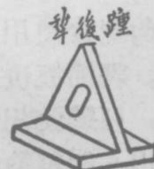
還起輔助調節垂直間隙（即立吃土）的作用。犁後踵使用過久，也會被土壤磨蝕，可以隨時更換新品。
